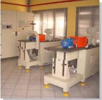
non può controllare sotto i 400rpm, e ciò inibisce il corretto controllo sullo spunto di un motore e qualsiasi verifica su un motore ad alto nr di poli.
