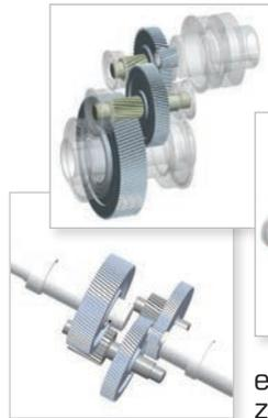
Untersetzungsverhältnisse von jeder Stufe, optimiert zwischen 2 und 6, kombiniert mit geeigneten Abmessungen der Zahnräder: Ergebnis sind größere und zahlreichere Zähne (Modul) auf jedem Rädergetriebe und eine bessere Aufteilung der Lasten zwischen den einzelnen Stufen.
