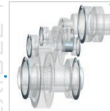
Die bewegten Bauteile sind in ihrer Position durch elastische Ringe und Zwischenstücke gesichert. Dadurch können größere axiale Lasten der vertikalen Montagen absorbiert werden und die Lebensdauer der Lager verlängert werden.
