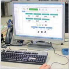
Die Einstellung und Steuerung kann mit dem kostenlosen PC-Schnittstellenprogramm „Motive Motor Manager“ auch vom PC aus erfolgen.
