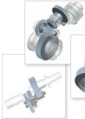
Der Gebrauch von zähem Stahl und Härtebehandlungen mit  $58 \pm 2$  HRC verringern den Verschleißgrad der Rädergetriebe. Zylindrische Verzahnung präzisionsgeschliffen Klasse 6 (DIN 3962), um höhere Leistung und geringere Geräuschentwicklung zu erhalten.
