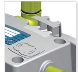
Die Druckgüsse von jedem VARIO werden gesandelt und dann lackiert, um die negativen Effekte der Porosität des Aluminiums und seine Oxidation zu vermeiden.
