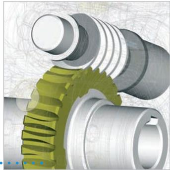
Um die Lebensdauer und Leistung zu verbessern, wird die Schnecke zementiert, gehärtet und die Verzahnung glatt geschliffen.
