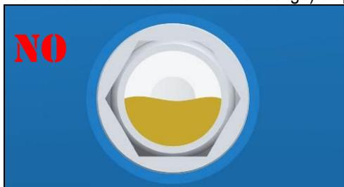
Nur in Position V5/V1, begrenzt auf die Größen ROBUSA2, 25 und 60, versichert die Bedeckung des Füllstandstopfens die korrekte Anwesenheit der Ölmenge nicht. Eine korrekte Ölmenge erlaubt, alle offenen Getriebe und Lager einzufetten. In diesen Fällen kann man deshalb, oder falls die Montage des Füllstandstopfens aus mechanischer Behinderung (möglich bei der Montage von B7 oder V5) nicht durchführbar ist, die korrekte Ölmenge mit einem Meßstab prüfen.
