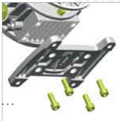
El módulo básico incluye la brida para la conexión a motores embrizados B5 y en el mismo se puede montar el pie rápidamente según las exigencias, reduciendo el volumen de almacenamiento y los tiempos de entrega
